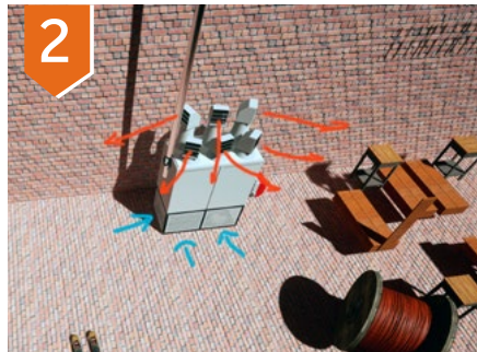
2 Generador de aire caliente con bocas de impulsión rotativas.
