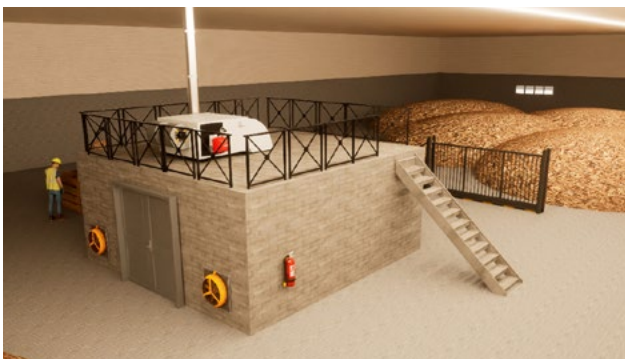
Instalación del equipo AGM en un proceso de secado de astilla. Installation of AGM equipment in a wood chip drying process. Installation d'un équipement AGM dans un processus de séchage de copeaux de bois.
