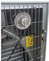
Motor a transmisión con base tensora
