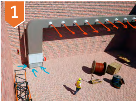
1 Generador de aire caliente con impulsión de aire mediante conductos y conos de alta inducción.
