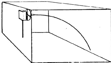
Curvar a mano (jamás con un instrumento) la sonda de 0,4 m, como indicado en la figura.
