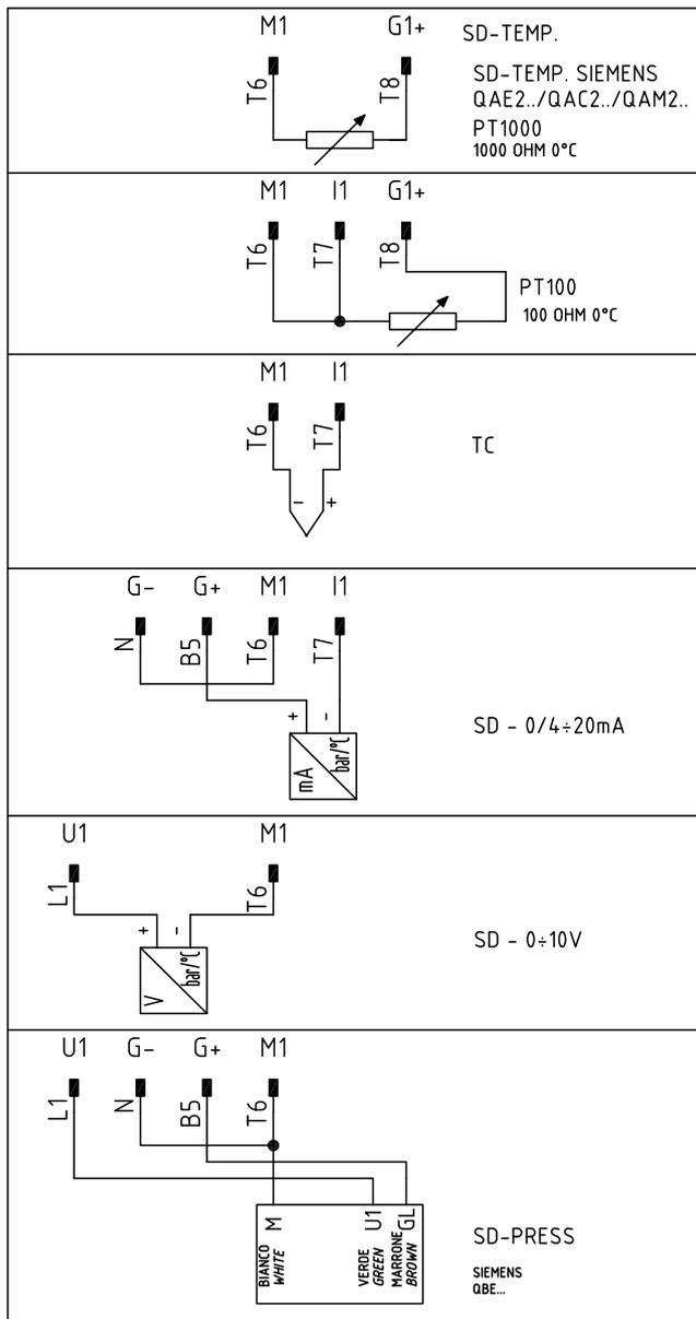
Fig. 13 - Conector 7-polos por conexión de las sondas
