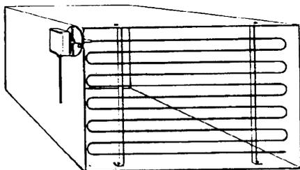
Disponer de toda la sección del canal, distancia mínima de las paredes 50mm, radio de curvatura 10mm para las sondas de 2 o 6 m.
