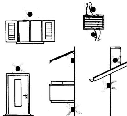
Evitar montaje en proximidad de ventanas, rejillas de aireación, al externo del local caldera, sobre chimeneas o protegida por balcones o cobertizos.
