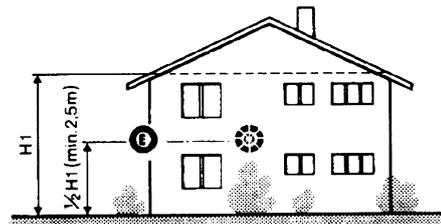
Regla general: en las paredes externas de la sala de estar del edificio. Jamás en la zona dirigida al sur o en posición de ser expuesta a las irradiaciones solares de la mañana. En caso de duda colocarla en el lado norte o noroeste.
