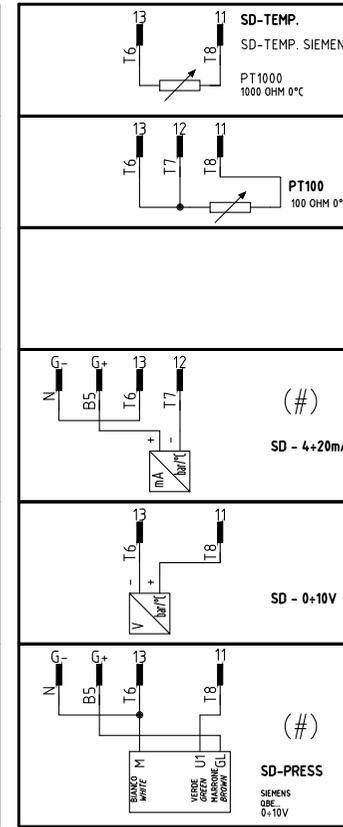
(#) COLLEGAMENTO SOLO PER TRASDUTTORI PASSIVI
