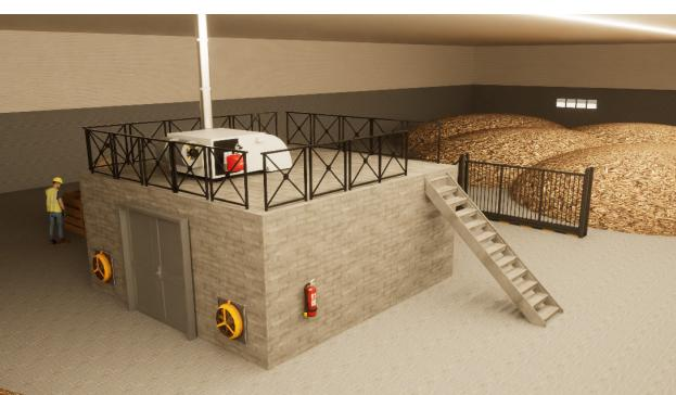
Instalación del equipo AGM en un proceso de secado de astilla.
