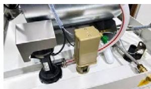
Bomba de agua, vaciado eléctrico y sensor de nivel
